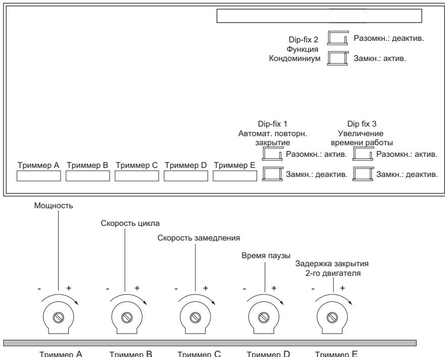
**Триммер А (мощность):** регулирует порог вмешательства электронного ограничителя мощности. Вращение против часовой стрелки увеличивает чувствительность (движение останавливается при более слабом сопротивлении); вращение по часовой стрелке снижает чувствительность и необходимо большее усилие для остановки двигателя; в этом состоянии двигатель может потреблять до 24А (576Вт) при максимальной скорости.
