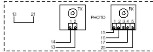
**Прим:** ФОТО1 вход не используется и должен быть подключен к клемме 13 для обеспечения правильной работы функции ФОТОТЕСТ.
