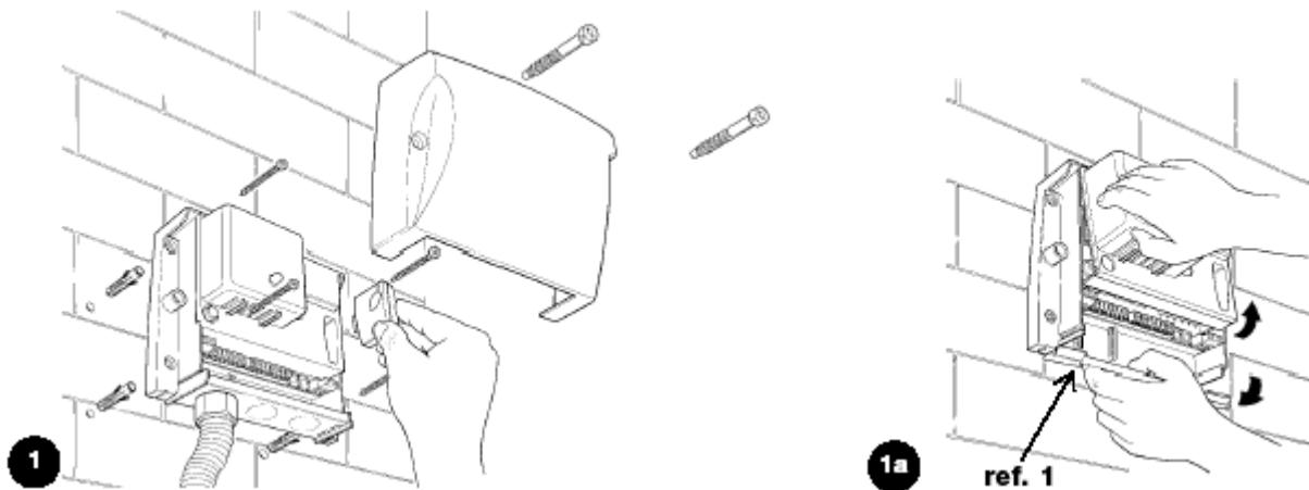
Контейнер закрепляется с защитной крышкой, которая предохраняет электронную плату от случайного контакта.
