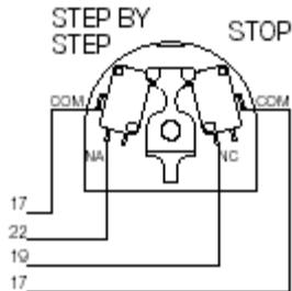
Подключение кнопки – ключа в соответствии с функцией “ПОШАГОВО” и “СТОП“
