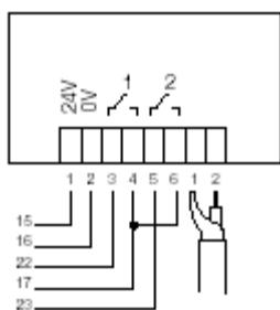
Пример подключения внешнего 24 В приемника.
