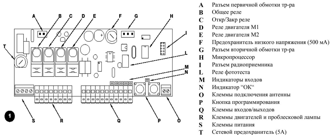
**⚠ Для защиты оператора и электронной платы от случайного повреждения, только клеммы подключения и кнопки программирования доступны. При необходимости защитная крышка может быть снята после отключения сетевого напряжения.**
