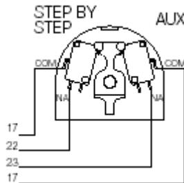
Подключение кнопки – ключа в соответствии с функцией “ПОШАГОВО“ и одной из AUX (вспомогательных) функций.
